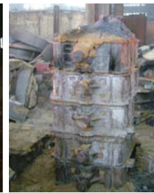
Рис. 5. Залитая форма вала мешалки смесителя.
