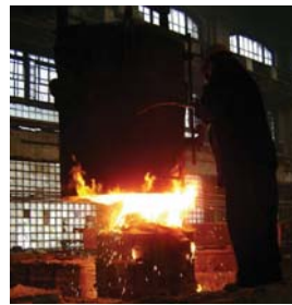
Рис. 4. Процесс заливки без выделения дыма.
