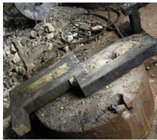
Рис. 3. Стальная отливка вала мешалки смесителя.
